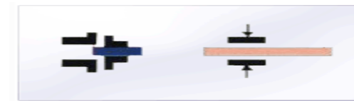
1. 용접재료를 SPINDLE축과 TABLE축에 고정
